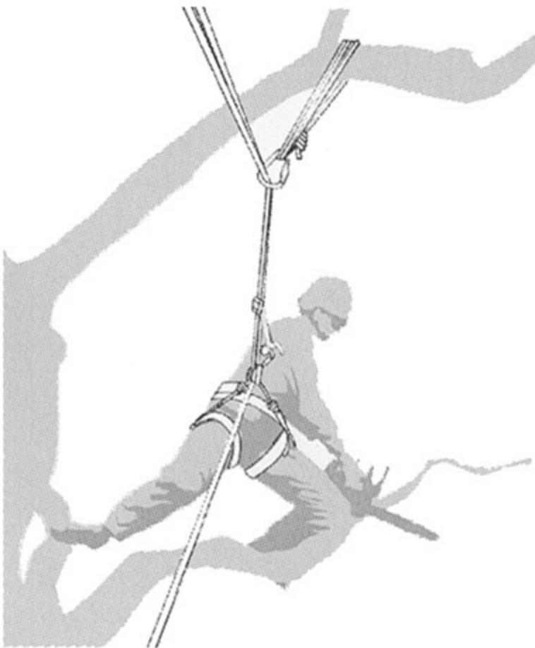
**Figura B.3 - Ejemplo de redireccionamiento de la línea principal a través de un punto de anclaje suplementario**
