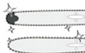
**(7)** Utilice únicamente barras y cadenas de repuesto especificadas por el fabricante o equivalentes.
