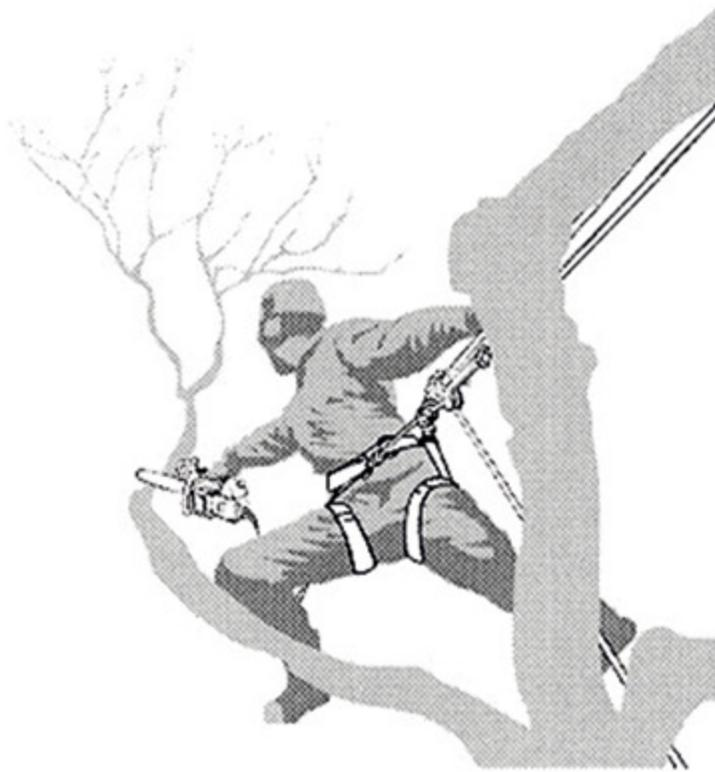
**Figura B.5 - Ejemplo de uso de una motosierra con una mano**
